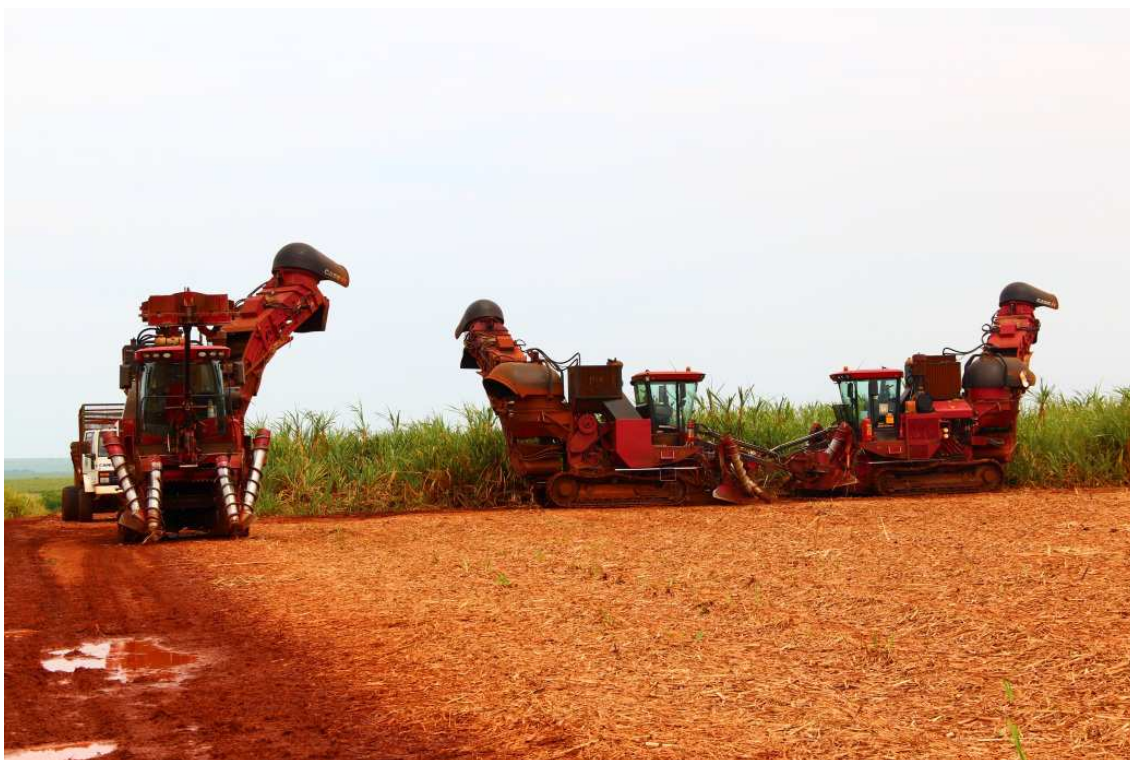
FIGURA 33. Colheitadeiras utilizadas pela colheita mecanizada e sem queima da cana crua na Usina São Francisco. (Foto: André Ferreira).
