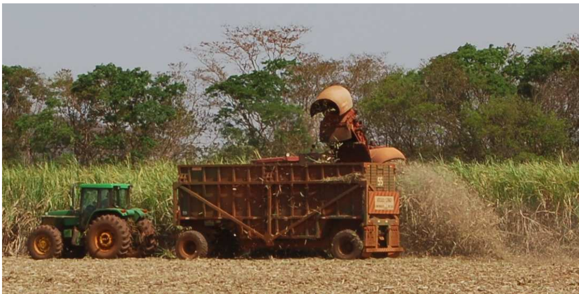
FIGURA 34. Colheita mecanizada e sem queima da cana crua. Detalhe para a palha da cana saindo pela parte de trás da colheitadeira e sendo depositada imediatamente no solo. (Foto: Vagner R. Ariedi Jr.).
