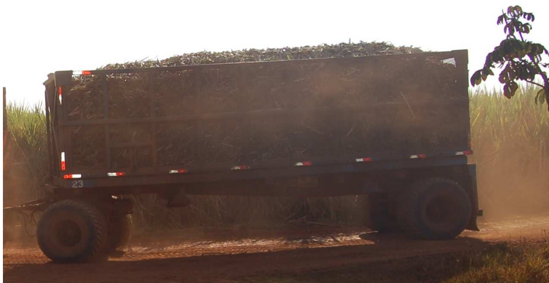
FIGURA 36. Detalhe da composição (caçamba) com pneus de alta flutuação para evitar ou atenuar o processo de compactação no solo no momento da colheita e transporte. (Foto: André Ferreira).
